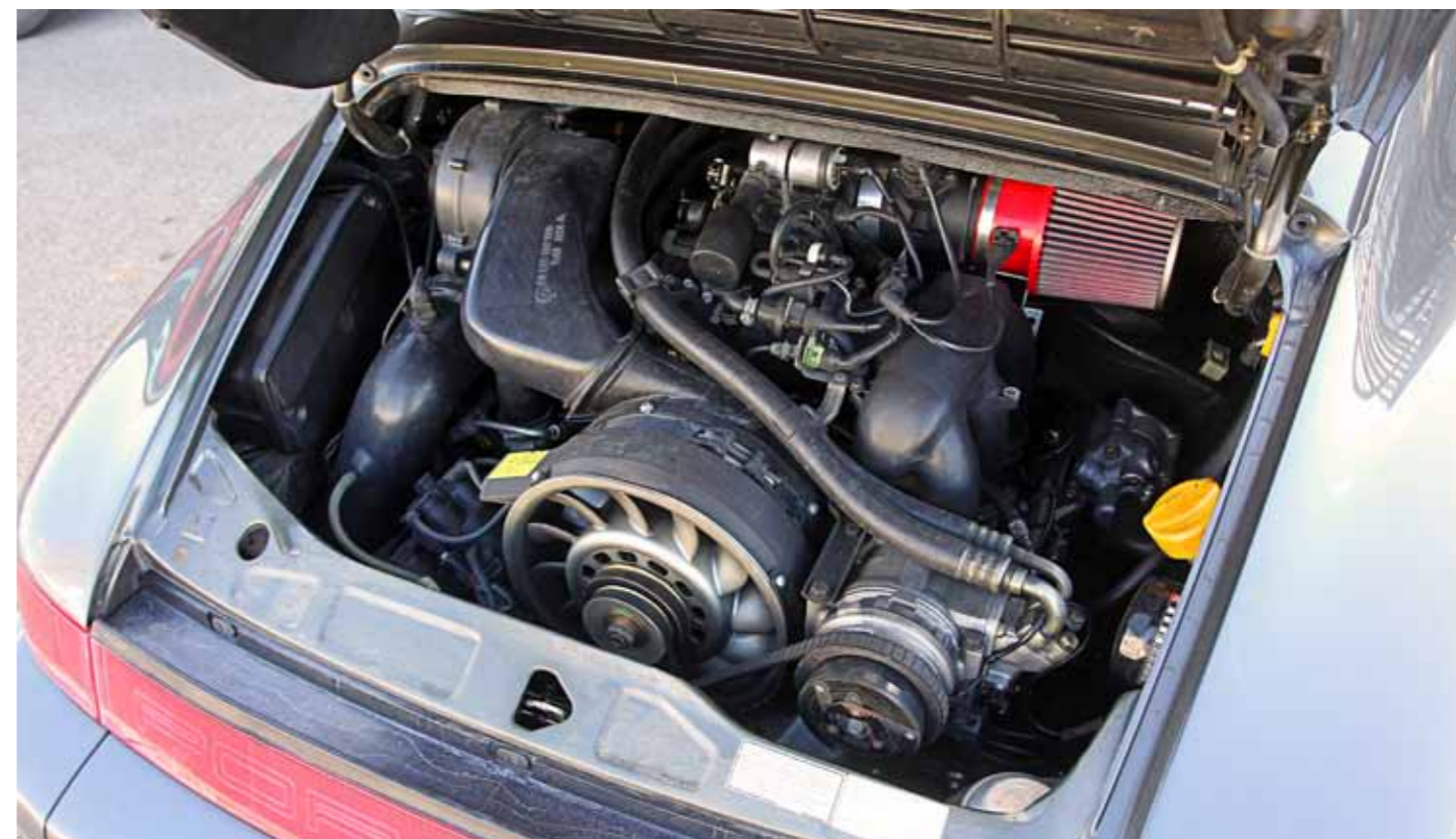
L'admission directe à film chaud apporte à la fois un gain de performances et un son plus sympa
