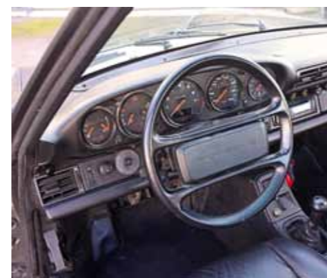
Avant l'arrivée des airbags, le volant était identique à celui des Carrera 3.2
