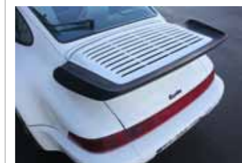
L'aile de la Turbo a à la fois un rôle aérodynamique et de refroidissement pour l'échangeur du turbo
